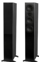
Diffusori da pavimento 3 vie con porta reflex. Dimensioni: (LxAxP) 132 x 938 x 310 mm; Risposta: 45 Hz – 20 kHz; Impedenza: 8 ohm; Sensibilità: 89 dB; Frequenza di taglio: 500/3500Hz; Altoparlanti: 1 x tweeter in seta da 25 mm, 3 x Mid/woofer da 100 mm; Finitura: Nero
