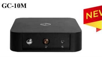
Word clock 10MHz di qualità HiFi che offre una qualità di streaming superiore e precisa. Specifiche: Porta di uscita del clock: 1 porta (BNC, placcata in oro); Impedenza della porta di uscita dell'orologio: Rilevamento automatico 50/75 ohm (il valore predefinito è 50 ohm); Dimensioni: 200(L)x62(A)x200(P)mm; Peso Netto: 2,8 kg / Lordo: 3,6 kg. Versione EU. Finiture: Nero e Argento
