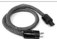
Cavo di Alimentazione multi schermo costruito con conduttori in Rame OFC e con Trattamenti TR10, sistemi di smorzamento delle vibrazioni AntiNoise, Doppio schermo. Spina Schuko in ottone rodiata e connettore femmina IEC in Rame rodiato da 10 A
