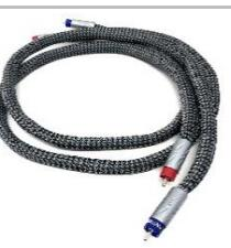
Cavi di segnale RCA multi schermo costruiti con conduttori in Rame OFC con Trattamenti TR10, con isolanti naturali e sistemi di smorzamento delle vibrazioni AntiNoise, connettori a bassa massa in Rame Argento.
